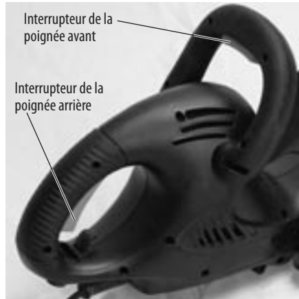
Figure 3-5 : Interrupteur des poignées avant et arrière
